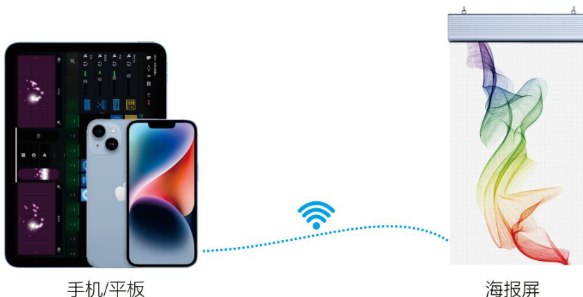
附录图 1-1 异步控制系统示意图
