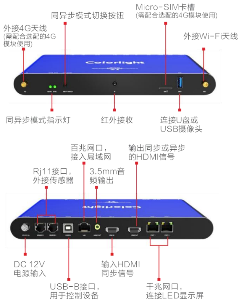
附录图 1-2 卡莱特控制盒·前面板（上图），后面板（下图）
